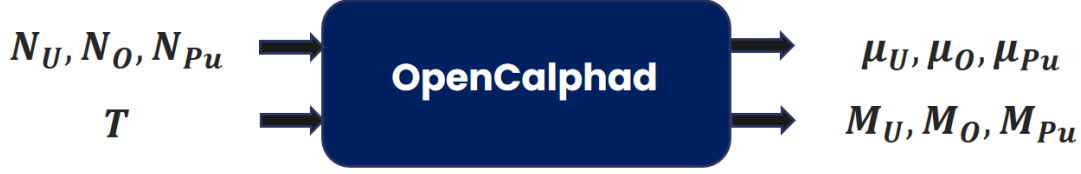
FIGURE 2 – Entrées et sorties du composant OpenCalphad, que l’on cherche à métamodéliser
