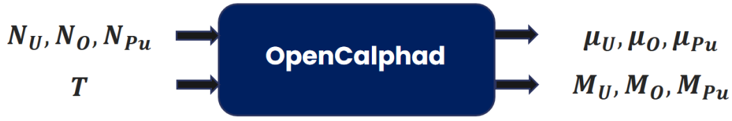
FIGURE 2 – Entrées et sorties du composant OpenCalphad, que l'on cherche à métamodéliser
